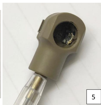
Bild 3: Defekt bleck på huva. Bleckets små "armar" syns inte.
